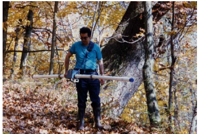
An EM survey over a stream bank.
